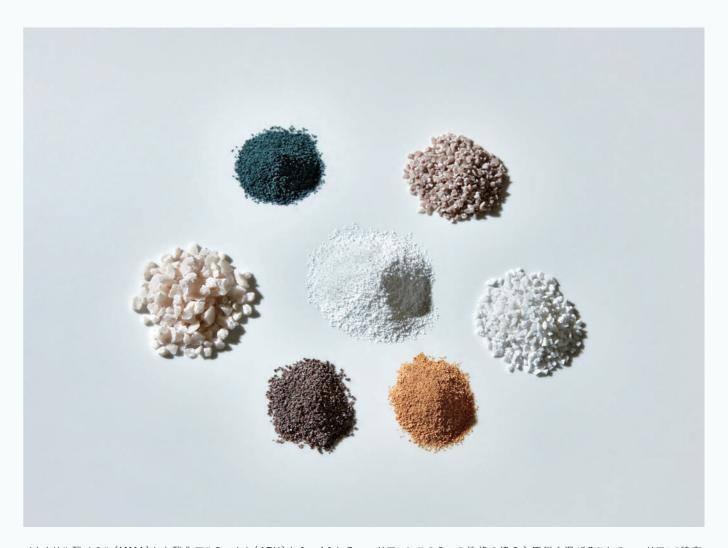
メタクリル酸メチル(MMA)と水酸化アルミニウム(ATH)からつくられるコーリアン\*。この2つの性格の違う主原料を混ぜることでコーリアン\*特有の性能が生まれる。主として鉱物由来の顔料(写真下)を加えることでソリッドカラーのバリエーションができ、さらにシート状のコーリアン\*を細かく砕いて粒状にしたクランチ(写真上)をプレンドすると、砂目柄や石目柄の製品になる。
