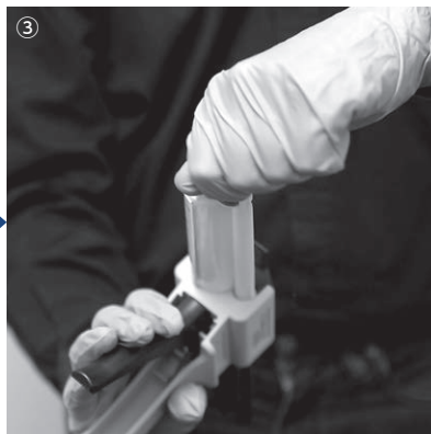
③ カートリッジを上に向けた状態でキャップを取り外します。
