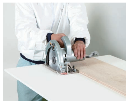
ストレートガイドを使った丸鋸での切断
