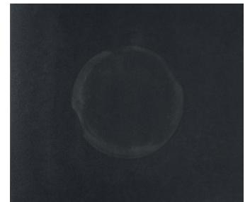
コーリアン®ディープノクターンを使用して実験を行った。表面に70%アルコールをたっぷりと吹きかけて、その上にガラスコップを8時間放置した結果、白い線が出現した。(社内実験)
